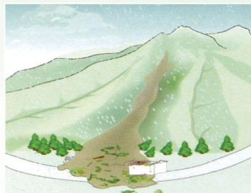
村庄和房屋不能建在冲沟沟口
